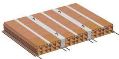
Solaio latero Cementizio calcolato per una portata di 200kg/mq oltre al peso proprio, realizzato in struttura laterocementizia del tipo a pannelli con soletta collaborante armata il tutto risultante dai calcoli statici.
