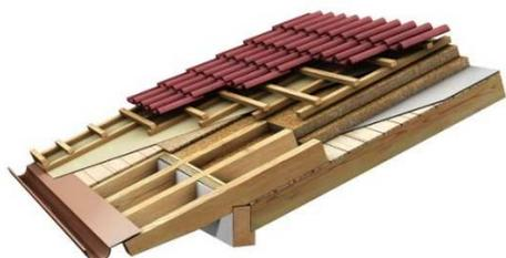
Copertura in legno lamellare ventilata dimensionata per un carico permanente (compr. peso proprio) 105+10 kg/m<sup>2</sup>, carico neve 120 kg/m<sup>2</sup>. Il tetto sarà a mono o doppia falda con struttura a travi e terzere in legno lamellare di abete GL24h, e correntini in DUO di abete C24 interasse ca. 80cm, compreso di pacchetto di copertura così costituito:
