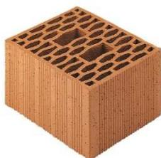
I muri di tamponamenti esterno saranno realizzati con Blocchi in laterizio modulari 25- 30 cm di spessore che grazie all'elevata porosità e massa frontale del laterizio garantiscono un isolamento termico ed acustico ottimale. All'esterno verrà poi installato un "cappotto" con funzione di isolante termica dello spessore di cm 18, rivestito con adeguati materiali resinosi.
