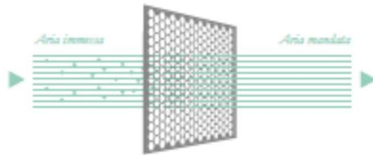
L'unità di recupero calore è dunque composta da due ventilatori di mandata ed estrazione che garantiscono il continuo ricambio d'aria tra l'ambiente e l'esterno. Il cuore della macchina è lo scambiatore di calore dove i due flussi d'aria di mandata ed estrazione si scambiano l'energia termica: l'aria di estrazione, più calda, preriscalda l'aria d'immissione ottenendo un rendimento ( $\eta$ ) che può anche superare il 90%.
