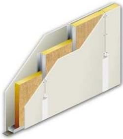
Le Pareti divisorie degli ambienti del piano primo saranno costituite da lastre di gesso fibrato accoppiate e rasate, montate su struttura in acciaio zincato con interposto materassino isolante in lana di roccia. al fine di garantire un elevato confort acustico.
