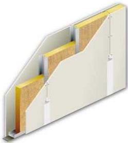
Pareti divisorie degli ambienti del piano primo costituite da lastre di gesso fibrato accoppiate e rasate, montate su struttura in acciaio zincato con interposto materassino isolante in lana di roccia. al fine di garantire un elevato confort acustico.
