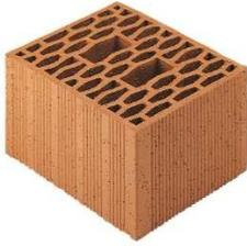
I muri di tamponamenti esterno saranno realizzati con Blocchi in laterizio modulari 25- 30 cm di spessore che grazie all'elevata porosità e massa frontale del laterizio garantiscono un isolamento termico ed acustico ottimale. All'esterno verrà poi installato un "cappotto" con funzione di isolante termica dello spessore di cm 18 e minimo 10 cm, rivestito con adeguati materiali resinosi.
